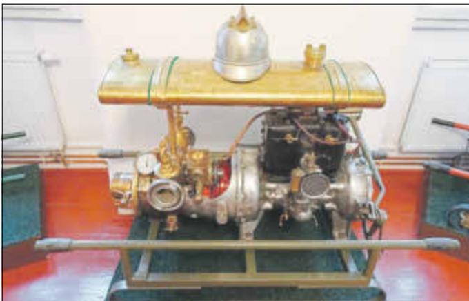
Tragkraftspritze der Firma „Flader“, Leistung 800 l Wasser pro min.
