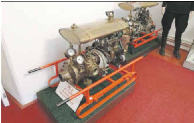
Verschiedene Tragkraftspritzen der Firma „Flader“
